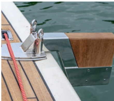
Die Außenborder-Halterung wird an der Backbordseite montiert.
